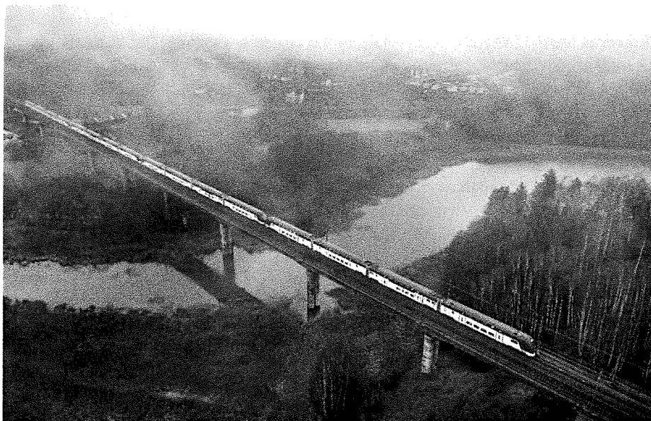
EKIPAGET PÅ BILDEN ÄR 420 METER LÅNGT, VÄGER NÄSTAN 1 000 TON OCH KAN TA EMOT 1 428 SITTANDE RESENÄRER. FOTO: JANN LIPKA
