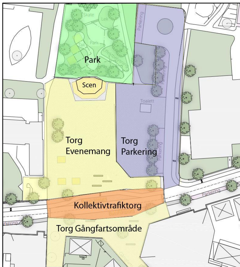
Illustration, principutformning av markbeläggning för olika torg och parkytor. I illustrationen står scenen delvis på parkområdet. Gult område bör utformas med gatsten, marksten och plattor, gråblått område tillåts till viss del att utformas med asfalterade körytor vilket även gäller för orange område.
