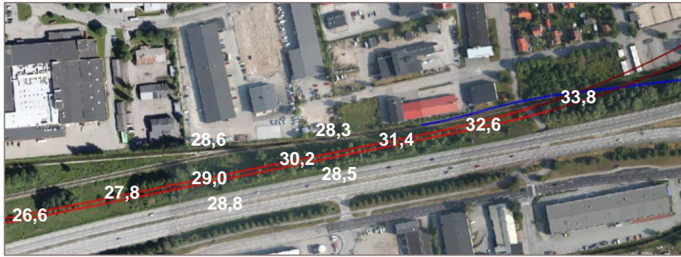
Figur 8. Höghastighetsjärnvägens sträckning med aktuell höjdsättning i möh.
