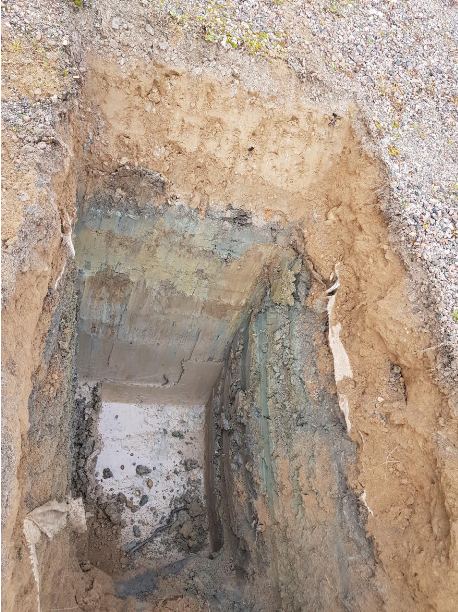
Figur 5. Fotot är taget på schaktgropen i provpunkt 21SW05 0,0-2,0 m där grundvatten syns i botten av gropen.
