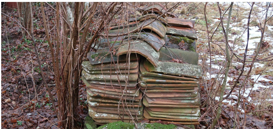
En av flera tegelstaplar i utredningsområdet med äldre handslaget lertegel som går att ta tillvara och återbruka.
