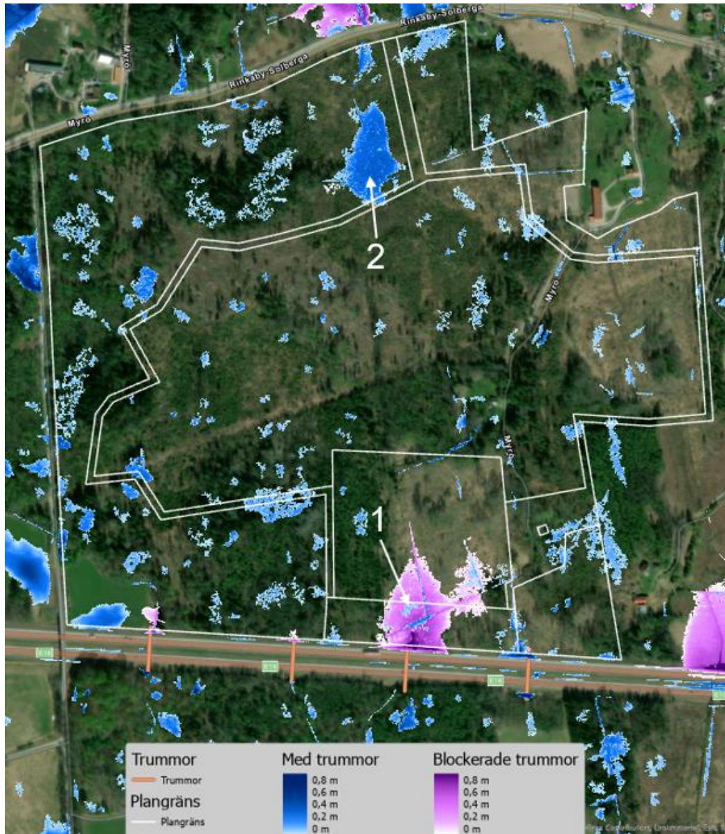
Figur 8. Vattenfyllda lågpunkter med blockerade vägtrummor (lila) samt med vägtrummor (blå) vid 70mm nederbörd.
