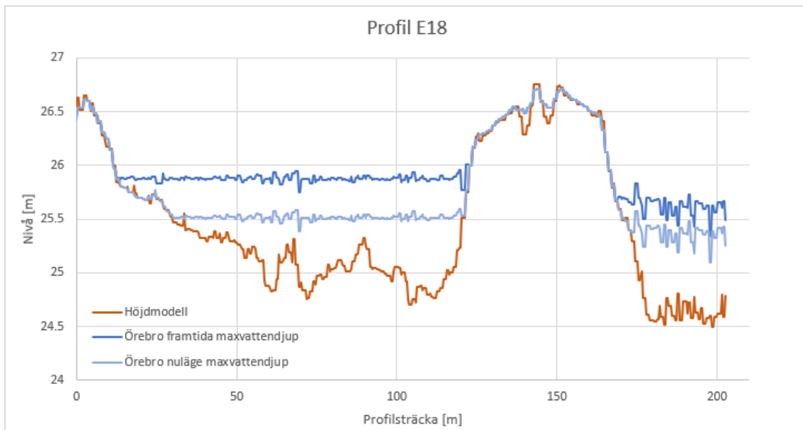
Figur 22. Profil dragen vinkelrätt över E18 för att visa maxvattendjup samt höjdmodellen som förtydligar vägbankens nivå i relation till stående vatten. Profilen är dragen vid vägtrumma nummer 1043 där den mest markanta dämningen är synlig.
