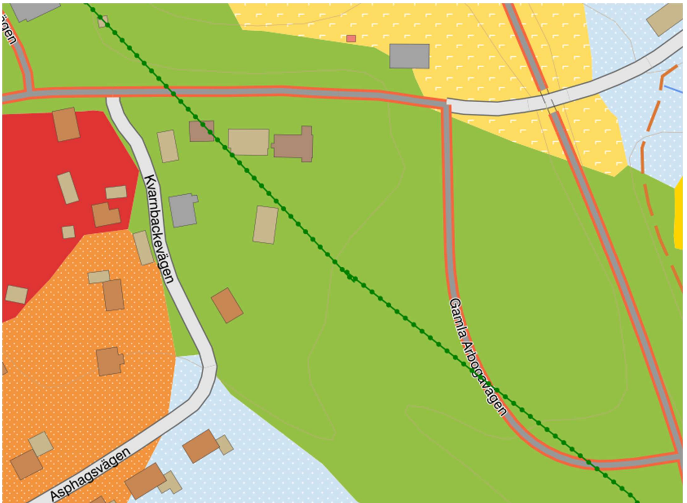
Utdrag ur SGU:s digitala jordartskarta som visar att jordarten inom det aktuella området främst består av isälvsediment.
