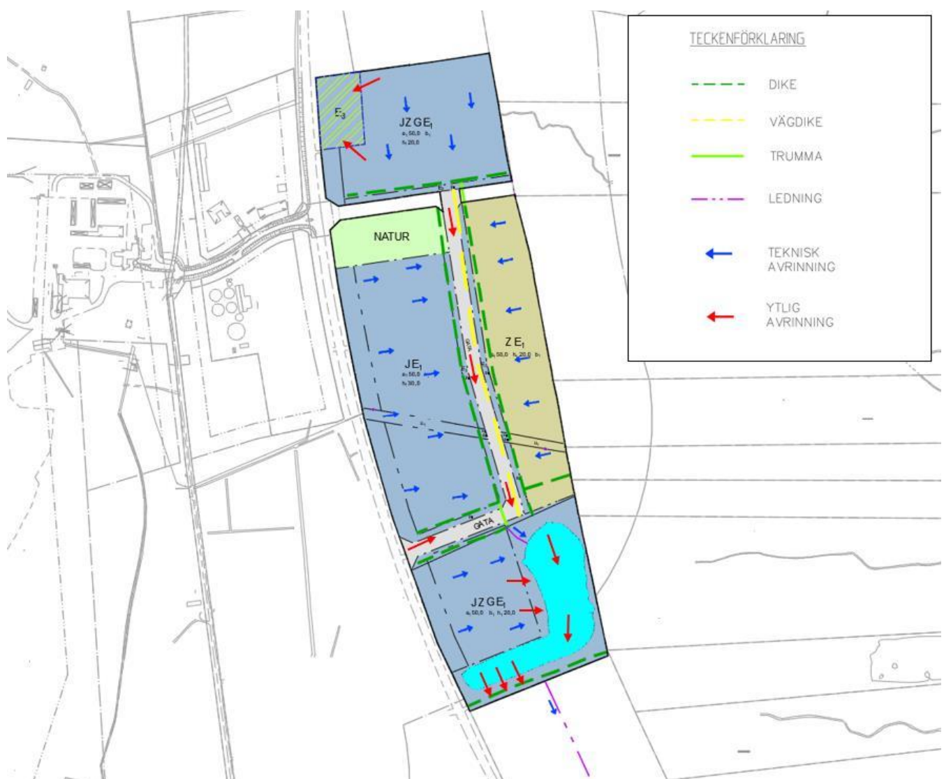
Figur 34. Översikt av föreslagen systemlösning. Ljusblå figur i sydöst motsvarar dagvattendamm, grön-streckade linjer diken inom kvartersmark, gul-streckade linjer svackdike längs med lokalgata och ljusgröna linjer motsvarar vägtrummor. Grönskrafferad yta i nordvästra hörnet motsvarar en föreslagen översvåmningsyta och ljusblå figur utgör föreslagen dagvattendamm. Utformning av dagvattendamm i figuren är ett förslag.
