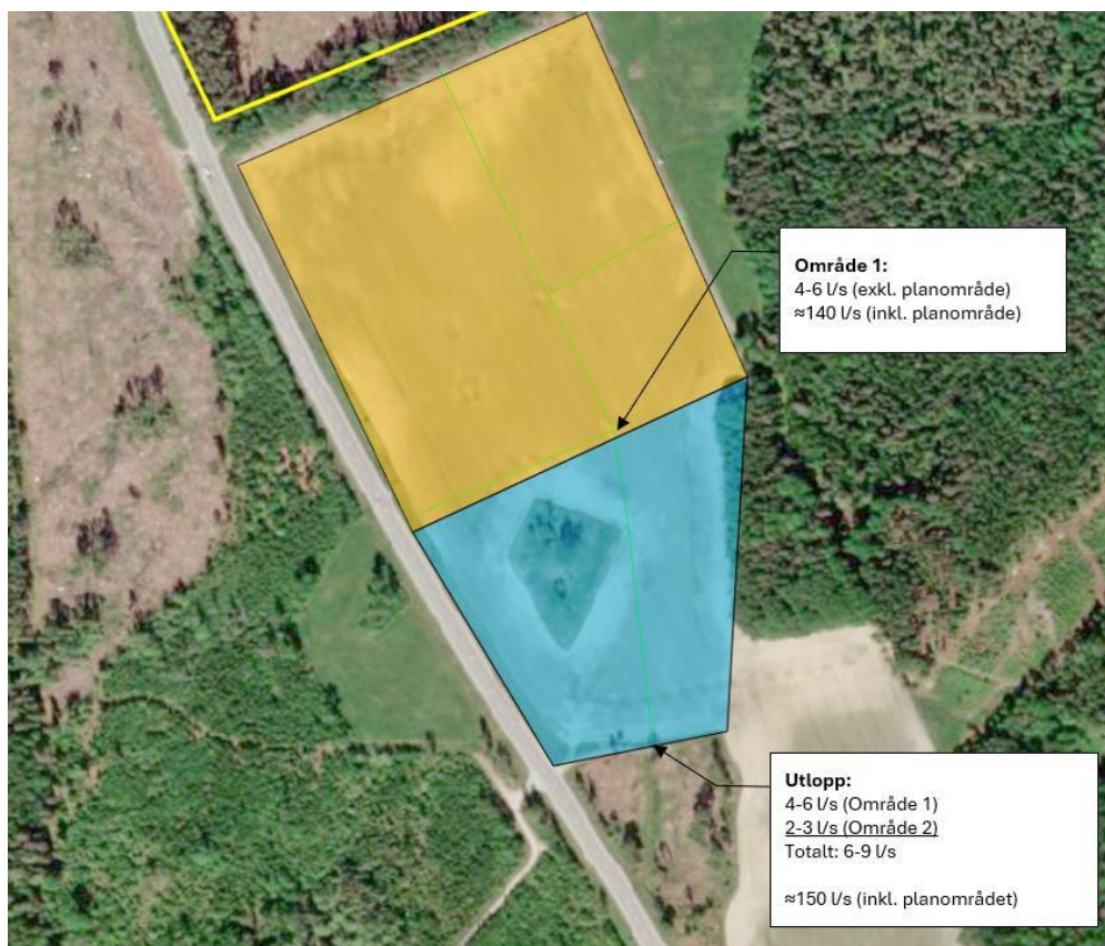
Figur 40. Beräknade flöden till dräneringsledningar, utifrån dimensioneringsvärden enligt Jordbruksverket (2013). Område 1 i orange och Område 2 i blått.
