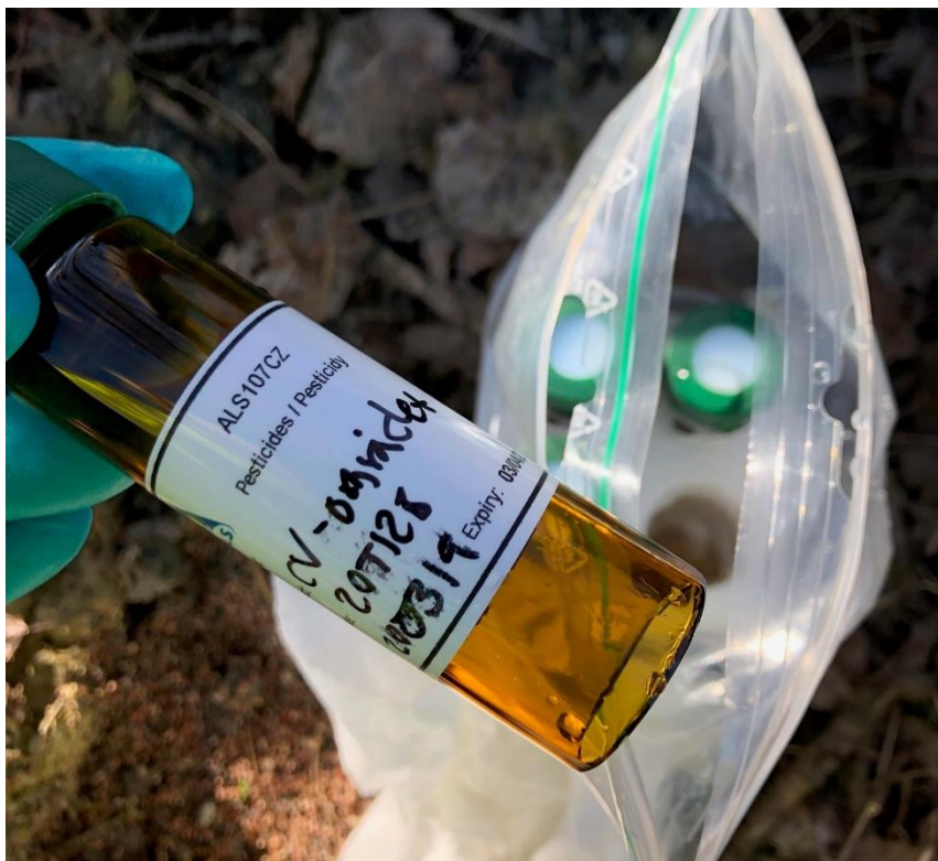
Figur 3. EPA-vial där botten helt plötsligt lossnade.
