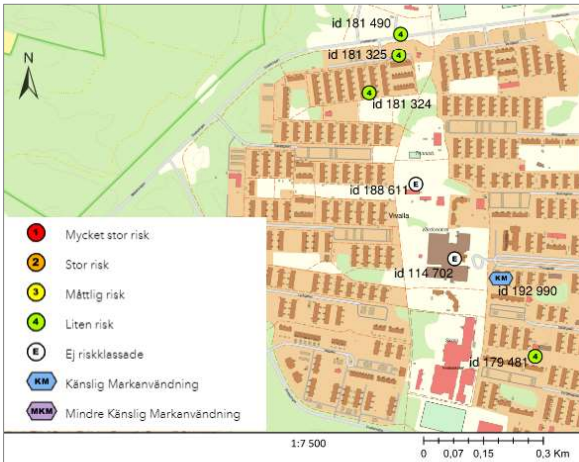
Figur 3. Tre MIFO-objekt i form av f d plantskolor finns nordväst om undersökningsområdet och ett sydöst om området, se gröna ringar med "4" i som visar att de bedömts tillhöra riskklass 4. Ej riskklassade objekt ("E") är id 114 702 som avser en f d drivmedelsstation och id 188 611 som avser en förskola där marken sanerats med avseende på PCB. Objekt markerat med blått "KM" visar område som sanerats, MIFO-objektet med id 192 990 är ett samlingsobjekt för PCB i Vivalla. Utdrag från Länsstyrelsens webbGIS 2024-05-29.
