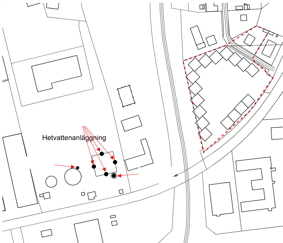
Figur 4. Markering av källor tillhörande hetvattenanläggningen.
