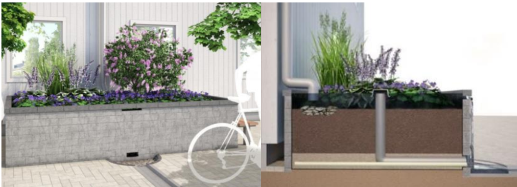
Figur 12-3 Exempel på upphöjd växtbädd som tar emot dagvatten från tak via stuprör (T. Lindfors, 2014).
