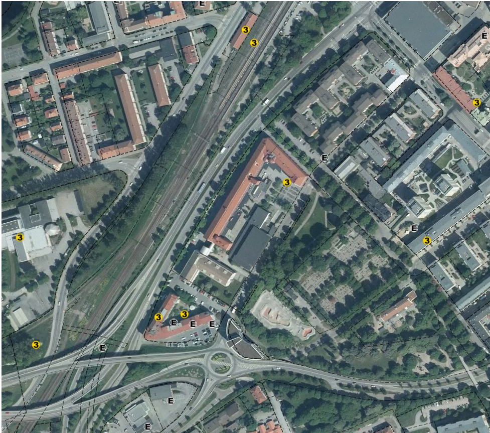
Bild över punkter inom och i anslutning till planområdet med identifierade och misstänkt förorenade områden. 3 = måttlig risk, E = ej riskklassad
