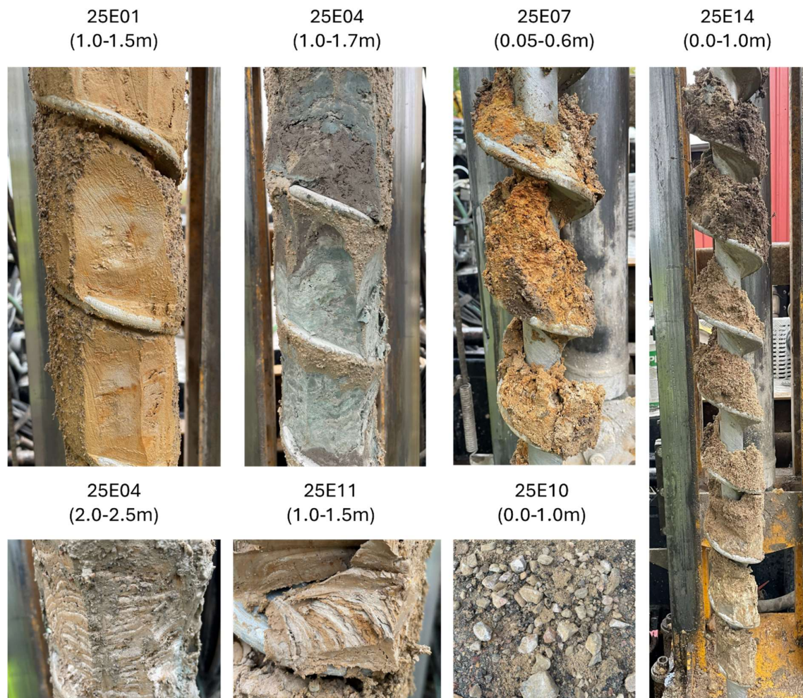
Figur 5. Sammanställning av bilder som visar ett urval av skrubborrprover med olika jordarter från 0,0-2,5m djup, utspritt över fastigheten Lindeshyttan 5:6. Bilder togs av miljökonsult från Ensucon i fält den 7:e och 8:e oktober 2025. © Ensucon AB
