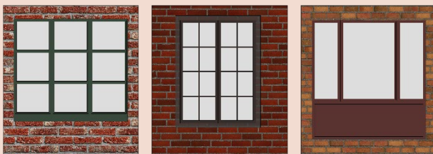
Figur: Industrikaraktär Fasadsnitt. 2 Arkad och fönster med industrikaraktär, kulör nära tegel, Södergruppen
