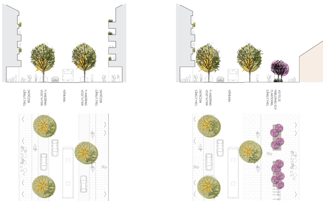
Schematiska sektioner som visar en alternativ utformning av nya CV-gatan med varierande gatubredder. Bildkälla: White/Jernhusen.
