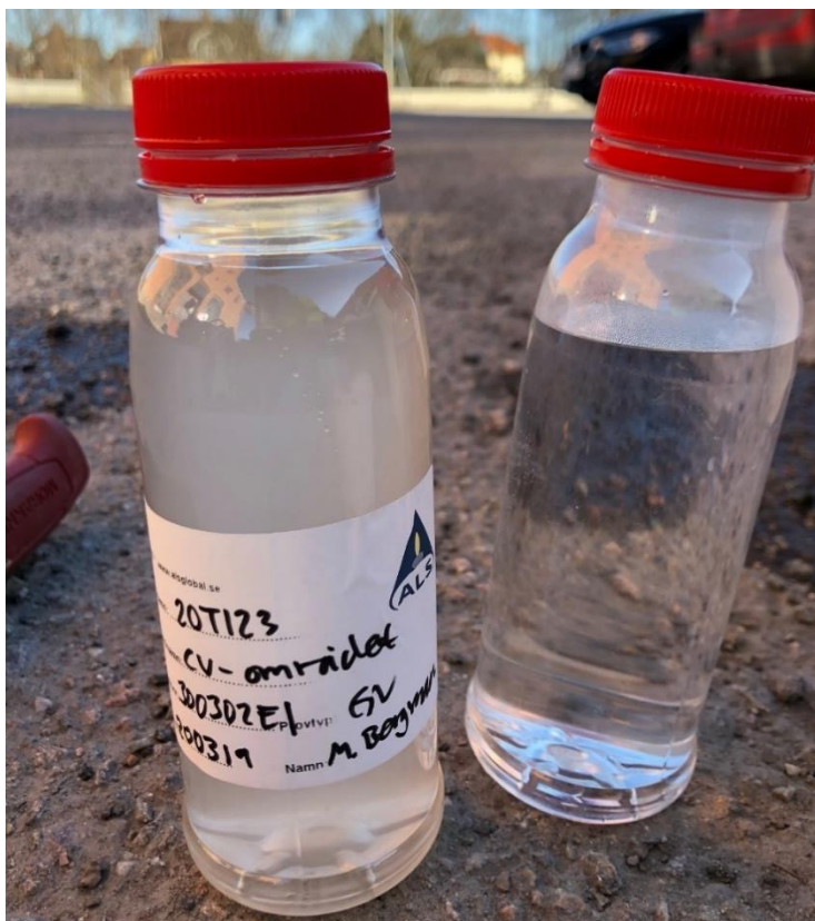
Figur 4. Grundvattenprov uttaget från rör 20T123, här i jämförelse med kranvatten för att se grumligheten/mjölkheten.
