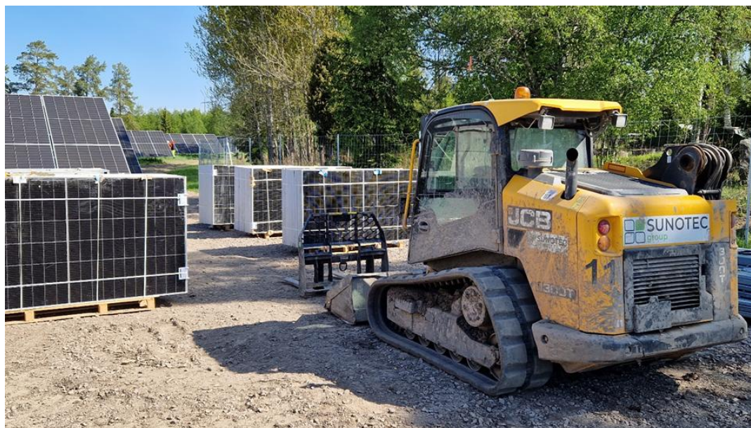
Figur 9. Exempel på mindre bandgående fordon som används för utkörning av solceller och material. Marktrycket är lågt.
