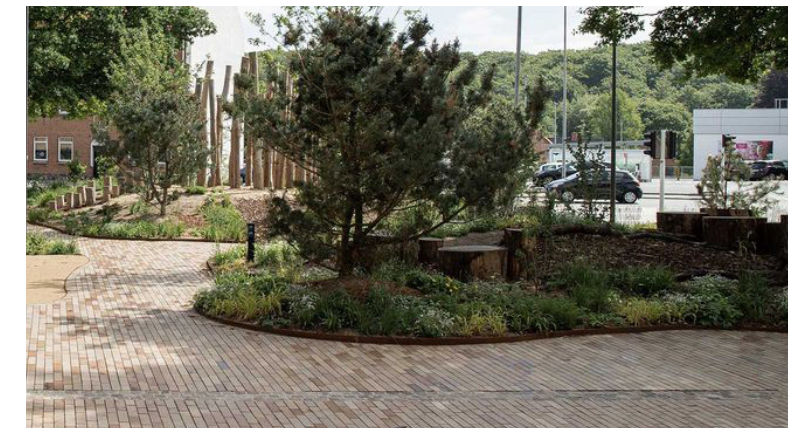
Bild 1. Öarnas höjd ovan mark kan variera. Dagvatten ska ledas in i planteringarna.
