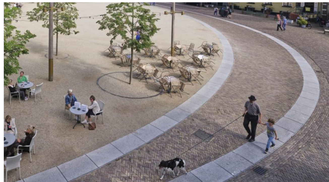
Bild 2. Materialval med stenmjöl och tegel hjälper till att skapa en mjuk övergång i gångfartsområdet mellan Eugenparken och Eugenplatsen. Källa: Foto: Jeroen Musch
