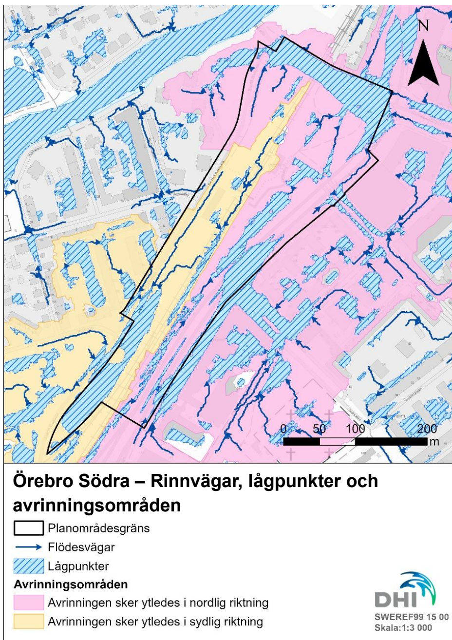
Figur 3-9 Rinnvägar, avrinningsområden och lågpunkter för befintlig situation. Underlag hämtat via SCALGO Live.
