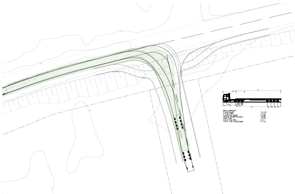
Figur 14 Körspår med specialtransport (24 meter med lastbredd 4 meter (skrafferad yta)) vid infart.
