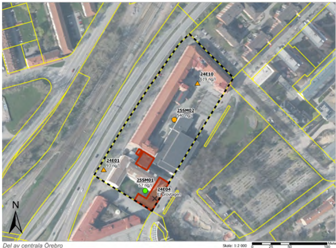
Figur 6.1 Flygbild med uppmätta maxhalter av PFAS11 från provtagningarna utförda 2024 (Ensucon) och 2025 (Structor Miljöteknik AB) redovisade.
