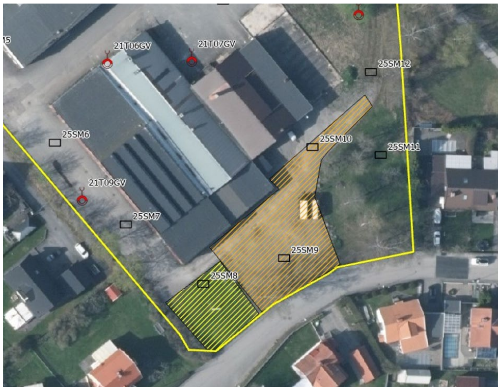
Bedömt åtgärdsbehov inom Orlången 3. Uppskattat område för rödfyr markeras med orange. Uppskattat område för PAH-H halt markerad med gult.
