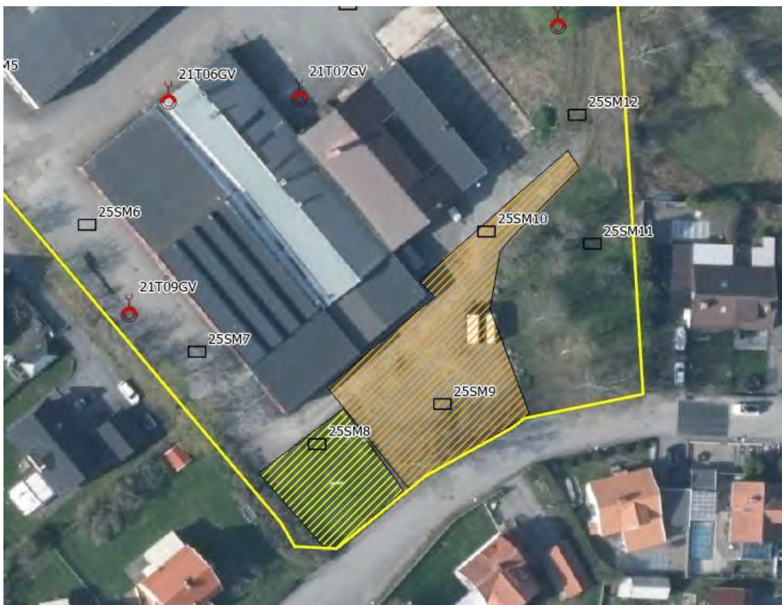
Figur 8.1. Bedömt åtgärdsbehov inom Orlången 3. Uppskattat område för rödfyr markeras med orange. Uppskattat område för PAH-H halt markerad med gult.
