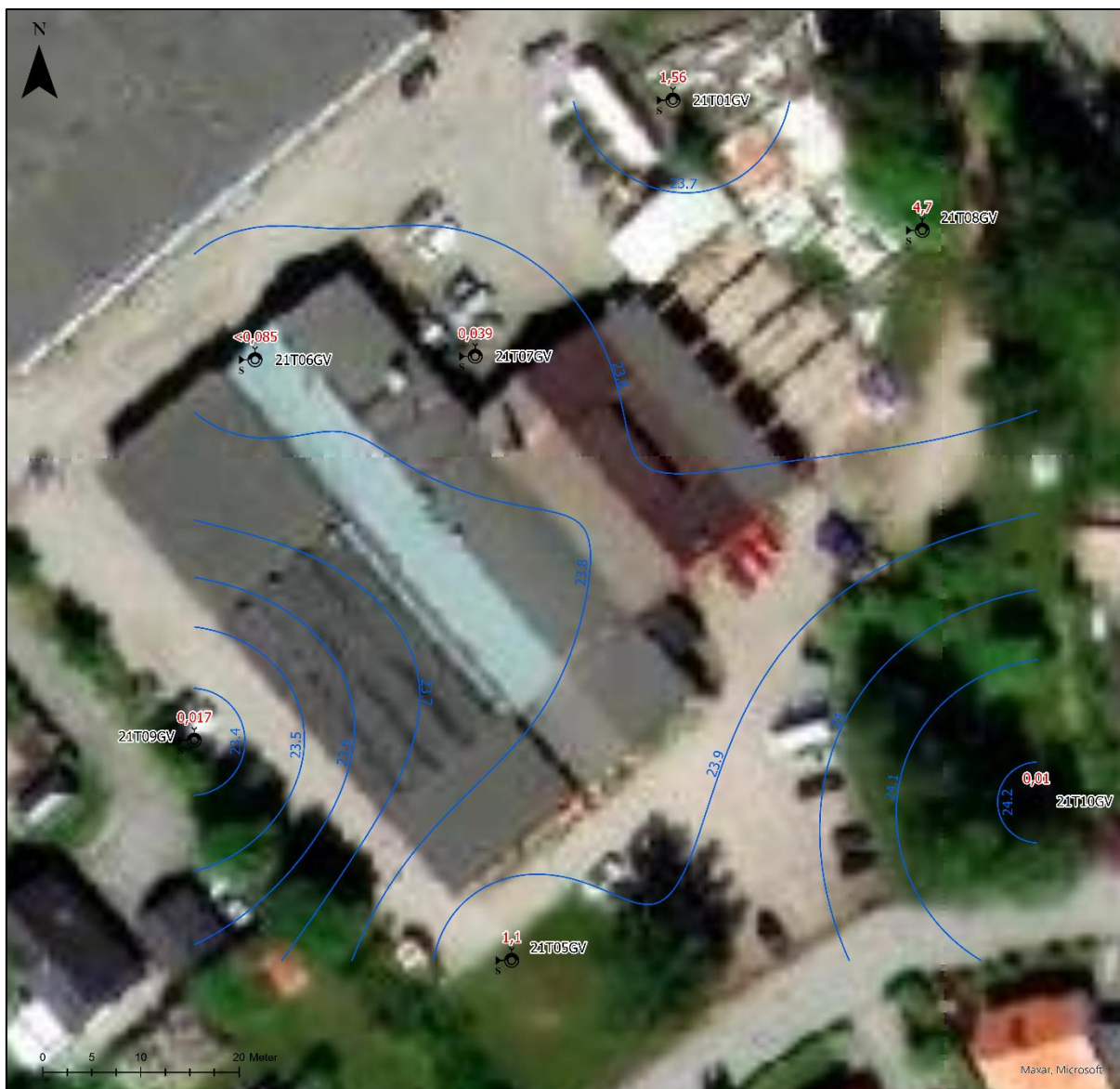
Figur 5. Resultat av interpolering av grundvattenytor inom fastighet Orlängen 3, Örebro kommun, med modellerade isolinjer markerade i blått. Uppmätta halter av PFAS summa 11 st ( \mu\text{g/l} ) redovisas i röd text.
