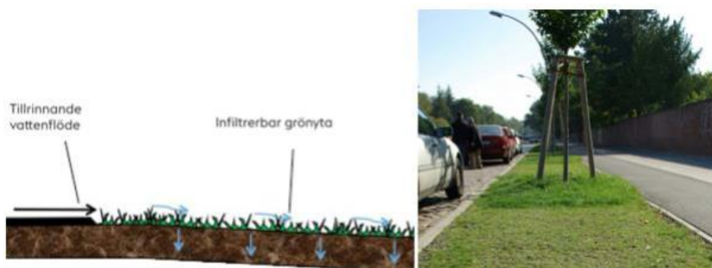
Figur 21. Principskiss för en infiltrerbar grönyta till vänster, exempel på en nedsänkt grönyta till höger. (Illustration av WRS)
